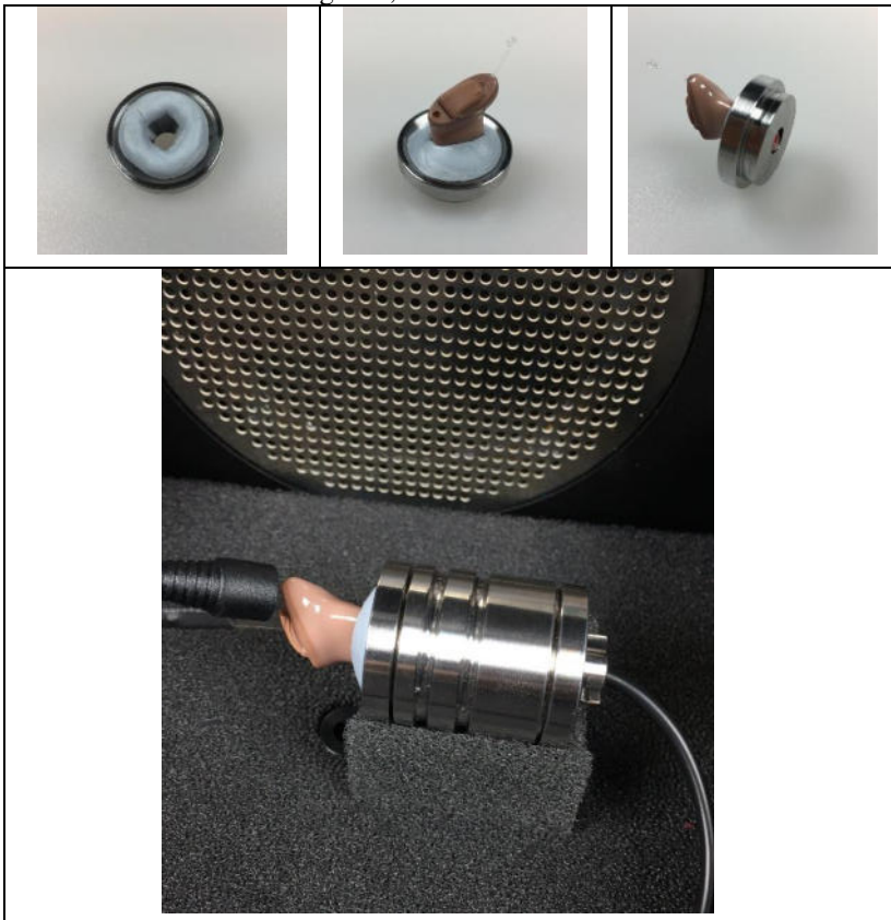
Anordnung der Hörgeräte vom Typ IdO, ITC und CIC
