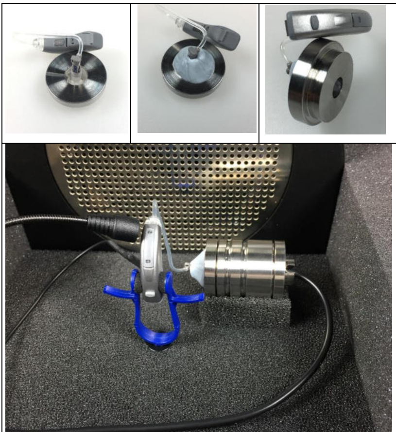
Anordnung des HdO-Hörgeräts mit dünnem Schlauch oder RIC
